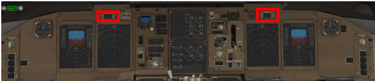
Die Autoland Status Annunciators (ASAs) zeigen, ob eine automatische Landung möglich ist.
